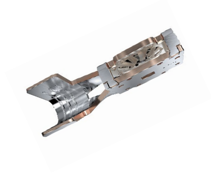
Powerkontaktstecker vom Bordnetz zur Batterie. Durch den Aufbau kann die Kontaktierung von drei Seiten erfolgen. Eine Lamelle fixiert den Stecker.
